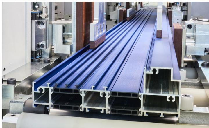
Führungselemente und Spanner automatisch angepaßt an breites, flaches Profil
