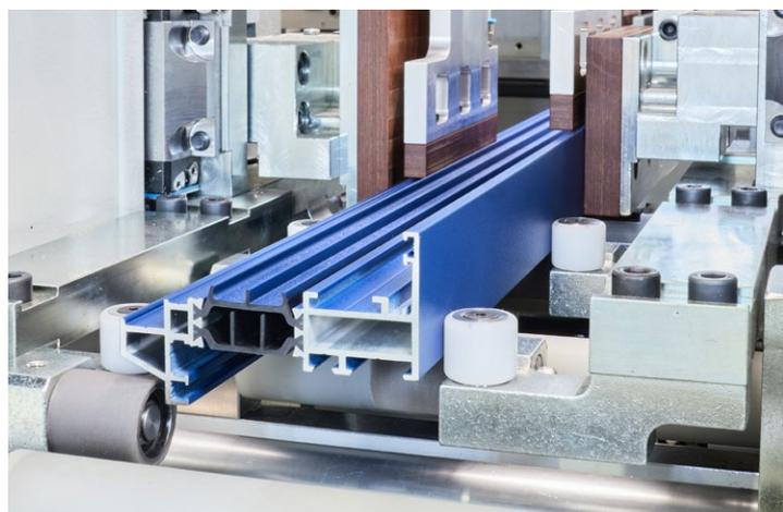
Führungselemente und Spanner automatisch angepaßt an komplexes Fensterflügelprofil
