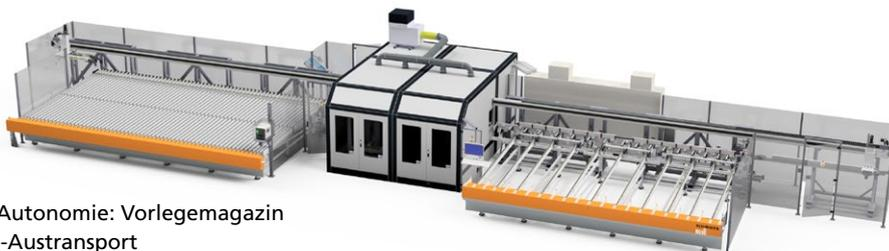
Alu-BAZ mit hoher Ausbringung: 2 separate Bearbeitungseinheiten inklusive Sägeeinheit
