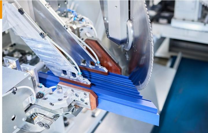
2 separate Servo-Spanner von oben für optimales Spannen
